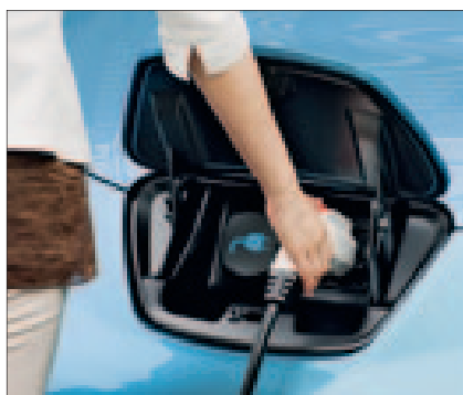
Der Anschluss des Ladegeräts ist über eine Klappe am Bug leicht zugänglich
